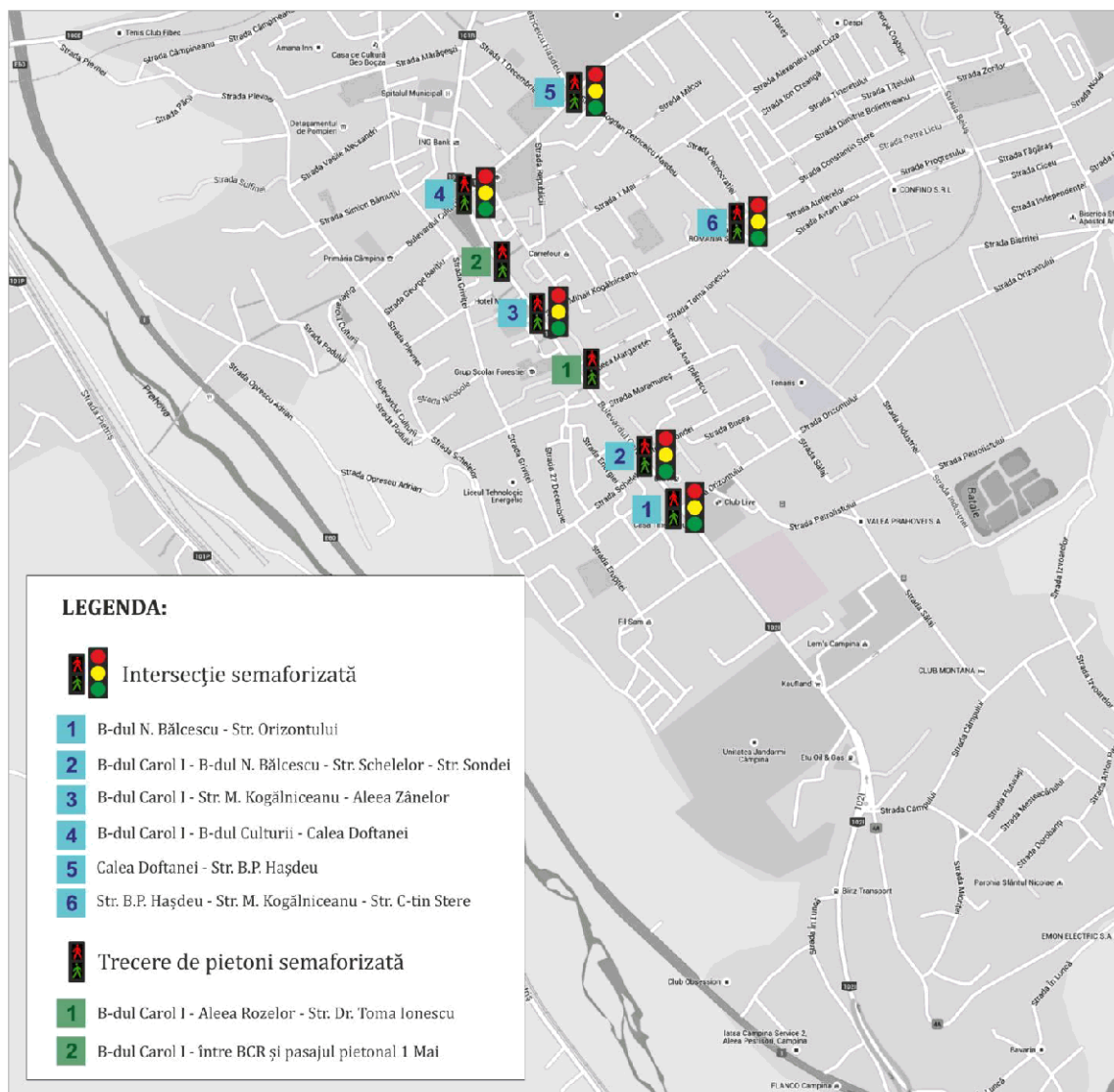
Figura 2.36. Intersecții și treceri de pietoni semaforizate.
