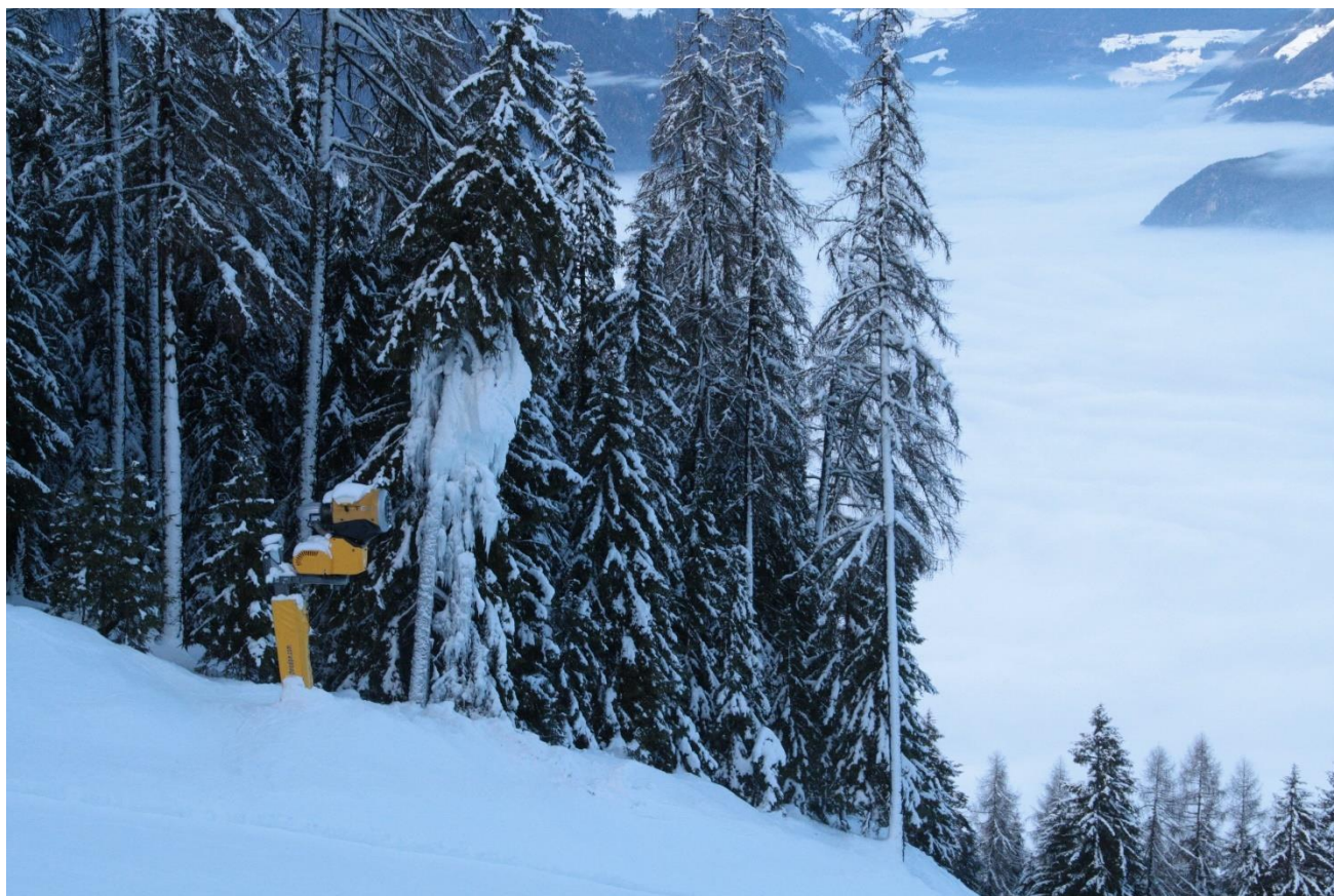
Soluție de amplasare a unui tun de zăpadă, camuflat într-un pâlc de arbori în scopul diminuării impactului vizual
