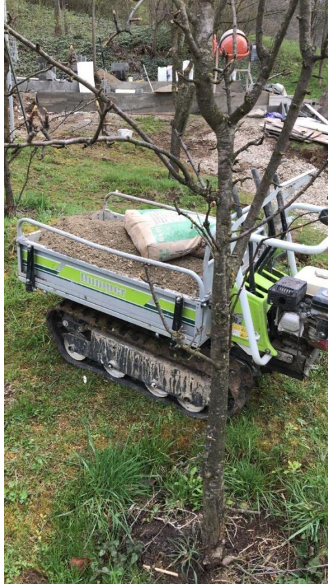
Figura 7. Minidumper pe șenile din cauciuc a cărui utilizare pe terenuri fragile asigură o protecție a solului și a covorului de vegetație
