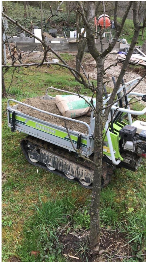
Figura 11. Minidumper pe șenile din cauciuc a cărui utilizare pe terenuri fragile asigură o protecție a solului și a covorului de vegetație
