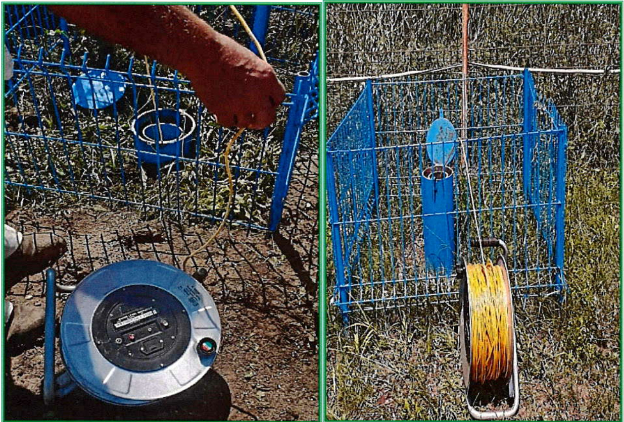
Determinarea nivelului apei in forajele de monitorizare
