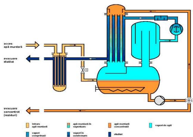
Apa distilata rezultata se analizeaza si in functie de parametrii determinati, poate fi destinta valorificarii, putand fi utilizata in diferite procese de spalare, curatare, racire etc., sau poate fi predata, in vederea tratarii ulterioare in statii de epurare si eliminata drept apa uzata.
