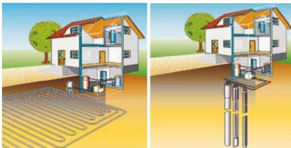
Figura 6.5 - Montarea serpentinei schimbătoare de căldură la o pompă de căldură sol-apă
