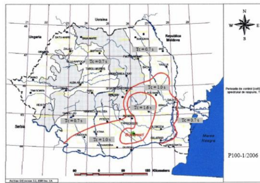
Figura 8. Zonarea teritoriului Romaniei in termeni de perioada de colt, Tc, a spectrului de raspuns
