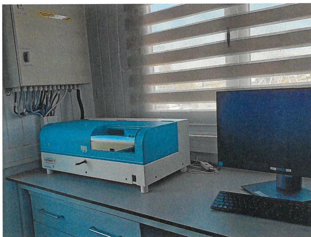
Analizor DMA-80 (utilizat pentru determinari metale- mercur)
